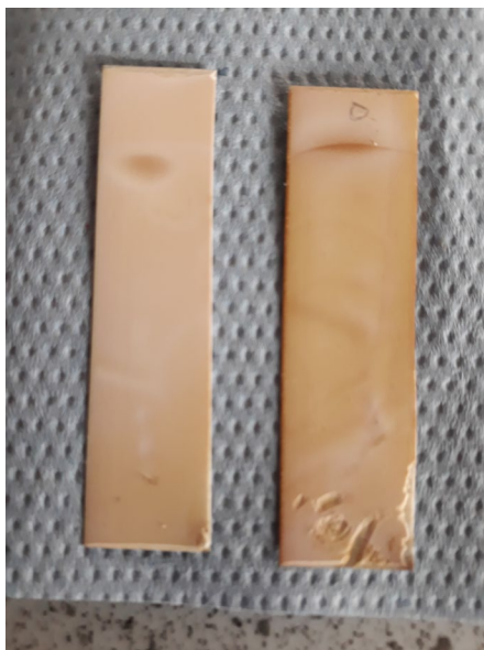
Σχήμα 1 : Πλάκες χρωματογραφίας λεπτής στοιβάδας με έλαιο πορτοκαλιού (αριστερά) και λεμονένιο(δεξιά) χρωματισμένα με υπερμαγγανικά Adrian Allan
