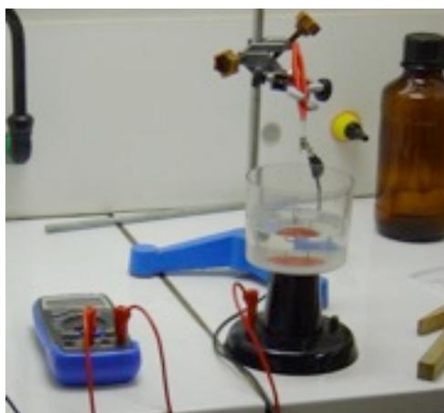
1. Posizionare il catodo in una soluzione di NaOH con concentrazione 1 mol/l.
