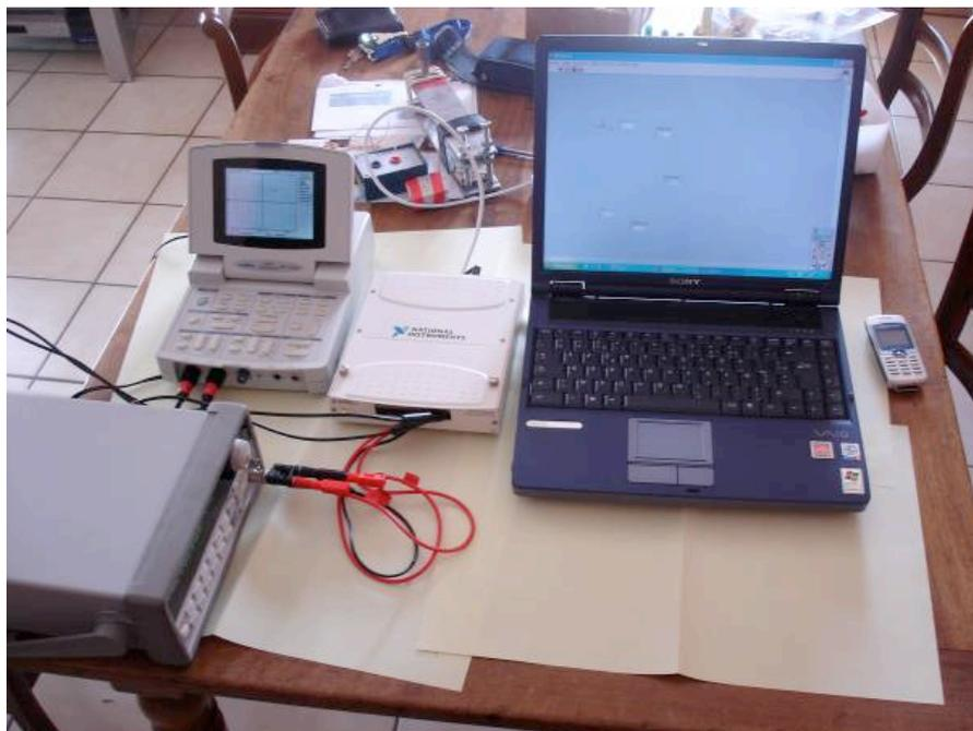
*Il nostro primo allestimento (da sinistra a destra): il generatore di segnale, l'oscilloscopio, la scheda di acquisizione dati National Instruments (NI) e il computer. In secondo piano potete vedere il vero e proprio apparato. Per utilizzare il microscopio è necessario posarlo a terra - su un tavolo le vibrazioni sono troppo forti.*
