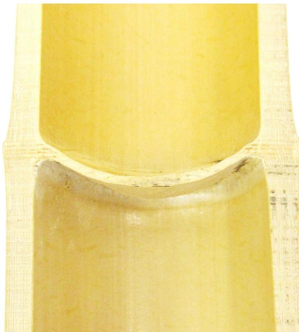
*Figura 1: Sección de una caña de bambú cortado longitudinalmente.*
