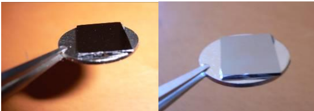
Een kwantumdoos met een zijde-lengte van circa 1 cm. Licht wordt onder sommige hoeken gereflecteerd.
