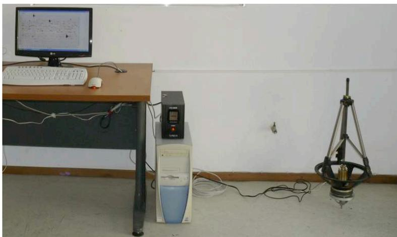
*El geófono está preparado. Tenga en cuenta que la señal de la pantalla se ha registrado con un sismógrafo comercial, no con el construido por nosotros. La caja negra sobre el ordenador es una batería.*
