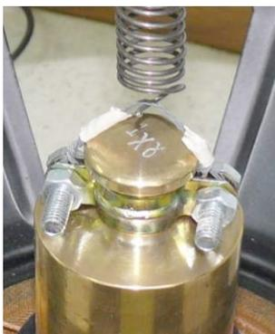
*Utilizamos un cable con un bucle sujeto con una pinza para colgar el peso del muelle*
