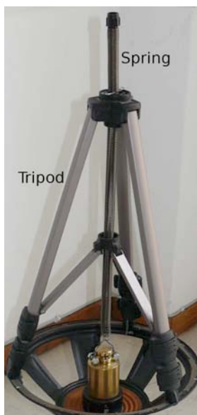
Το ελατήριο με το μεταλλικό κολάρο και το άγκιστρο Η εικόνα προσφέρθηκε από Panteleimon Bazanos
