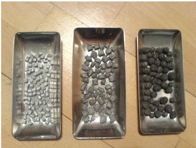
*Pyrotechnische Sterne, von links nach rechts: gepumpte, geschnittene und gerollte Typen von Pellets*
