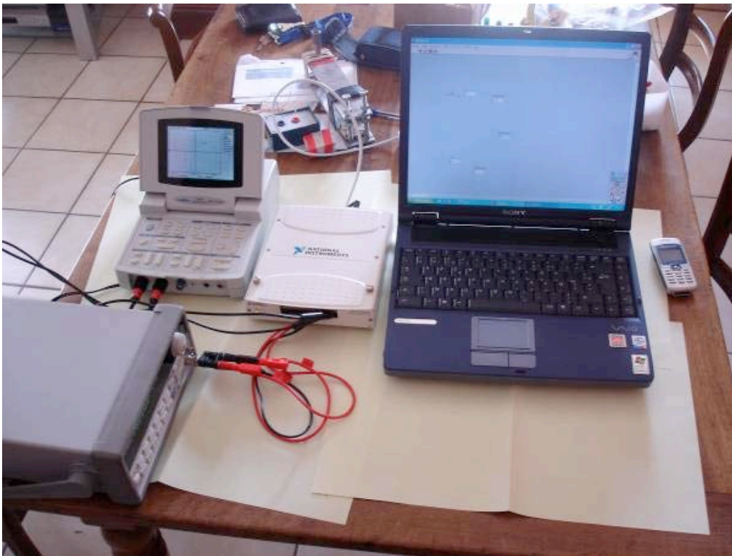
Unsere erste Konstruktion (von links nach rechts): Der Signalgenerator, das Oszilloskop, die DAQCard von National Instruments (NI) und der Computer. Im Hintergrund sieht man die tatsächliche Mikroskopaufstellung. Um das Mikroskop zu benutzen, muss man es auf den Boden stellen – auf einem Tisch wären die Vibrationen zu stark
