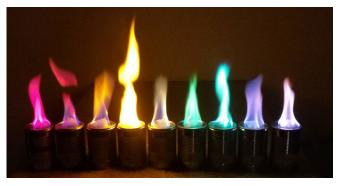
Häufig werden im Unterricht Flammenproben für Metallionen durchgeführt. Eine effektive Lehrkraft kann zusätzlich eine Demonstration zeigen, um entweder in das Thema einzuführen, das Verfahren beispielhaft vorzuführen oder im Nachhinein das Verständnis zu überprüfen. Besonders spektakulär ist die Demonstration der Regenbogenflamme.
